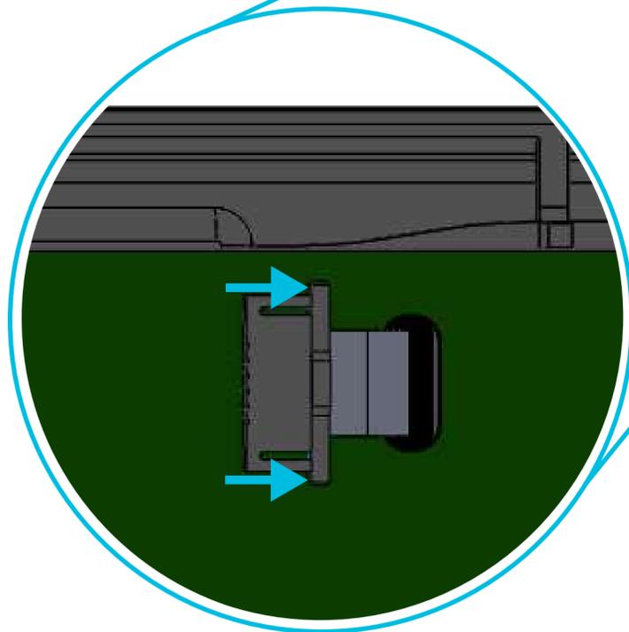
5.1. Poussez le clapet du connecteur à l'aide des deux extrémités
