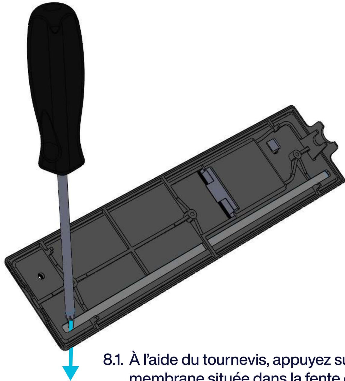
8.1. À l'aide du tournevis, appuyez sur la membrane située dans la fente de la façade du boîtier.
